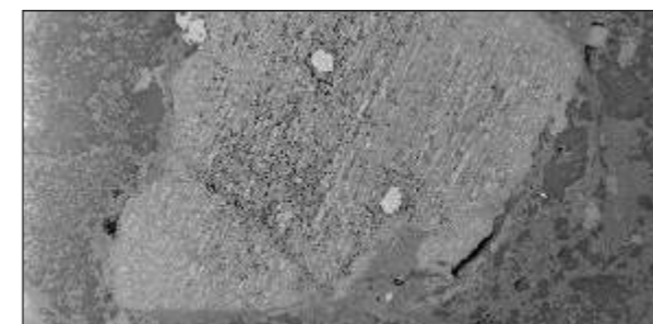
REM-Bild titanhaltiges Partikel
