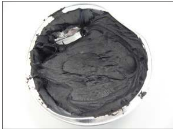
ausgehärtete i.O.-Probe, dauerelastisch (58 Shore A)
