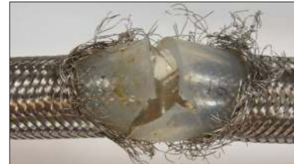
Schadensfall: gerissener Spülschlauch
