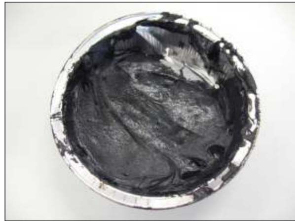
ausgehärtete n.i.O.-Probe, unelastisch (95 Shore A)
