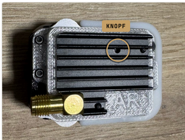
A · Der Knopf sitzt am Grund eines kleinen Lochs im gerippten Kühlkörper — nicht im grösseren Loch näher an der Antennenbuchse.
