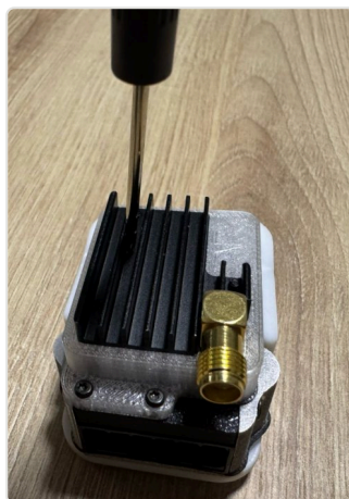
B · Drücke mit einem dünnen Schraubendreher oder SIM-Werkzeug gerade nach unten.
