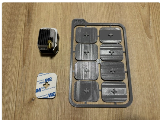
A · Panoramica — la Pro-Box, un pad con il suo nastro applicato e il supporto dei pad.
