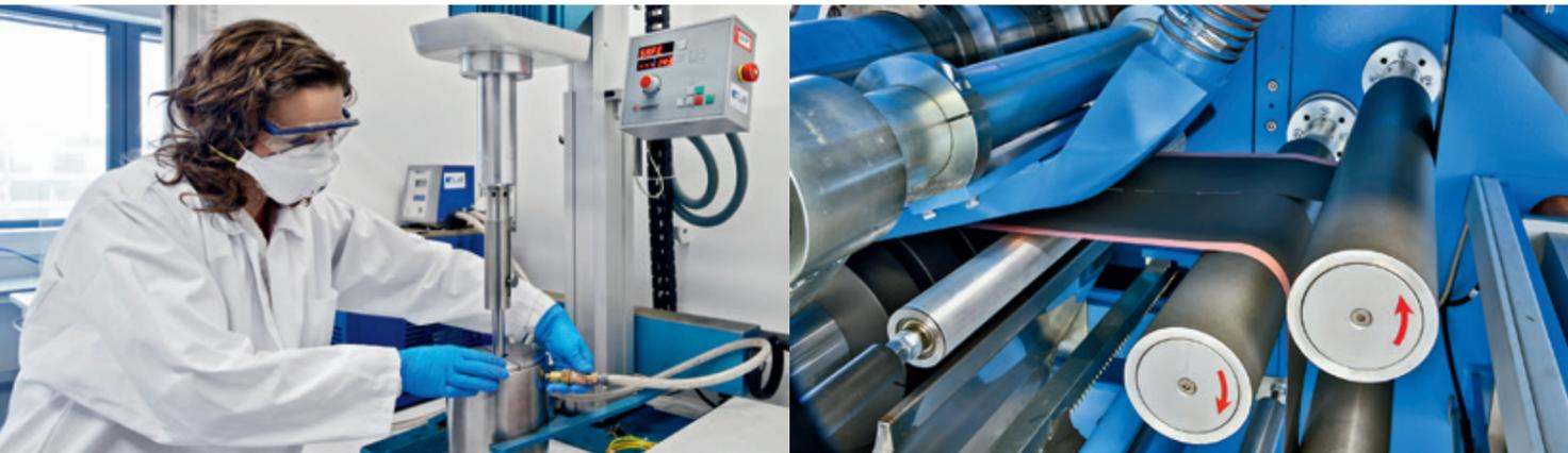
Neue Materialien ermöglichen Fortschritte in der Performance von Batterien. Indem sie zu Elektroden und Vollzellen verarbeitet werden, können Eigenschaften und Wechselwirkungen mit anderen Zellbestandteilen geklärt sowie ihre Einsatzmöglichkeiten analysiert werden.
