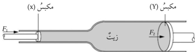
نظام الكوابح في السيارة. مستعيناً بالشكل احسب مقدار الضغط على الزيت المحصور في الأسطوانة، الناتج عن قوّة مقدارها  $90 \text{ N}$  تؤثّر في مكبّس الأسطوانة (Y)، علماً بأن مساحة سطحه  $(20 \text{ cm}^2)$ .
