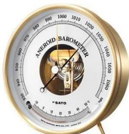
☒ تبين الصورة باروميتر زئبقي يستخدم في قياس الضغط الجوي ويسمى باروميتر (لا سائل) (Aneroid Barometer).
