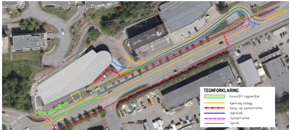
Figur 18: Illustrerer forslag til prinsipp for mobilkran foran Bentley og bevegelses- og kjøremønster på veier for myke trafikanter, kjørende og anlegg.
