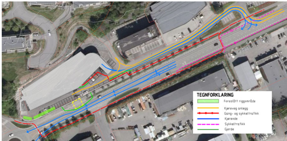
Figur 17: Illustrerer forslag til prinsipp for mobilkran på fortauet og bevegelser- og kjøremønster på veger for myke trafikanter, kjørende og anlegg.
