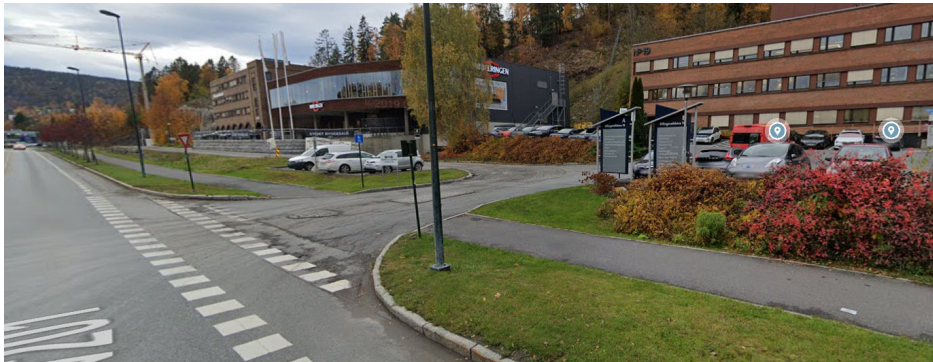
Figur 6: Skjerm bilde fra Google Maps i kjøreretning mot Holmen. Her vises det at det er begrenset sikt på grunn av informasjonsskilt.
