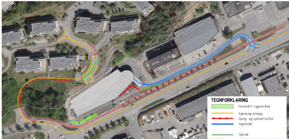
Figur 19: Illustrerer forslag til prinsipp for mobilkran ved Billingstadlia og bevegelser- og kjøremønster på veger for myke trafikanter, kjørende og anlegg.
