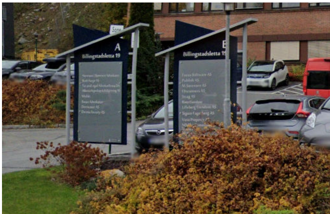
Figur 9: Skiltene er helt eller delvis innenfor siktretkanten. Buskene og høydeforskjellen i terrenget bidrar til dårligere sikt.
