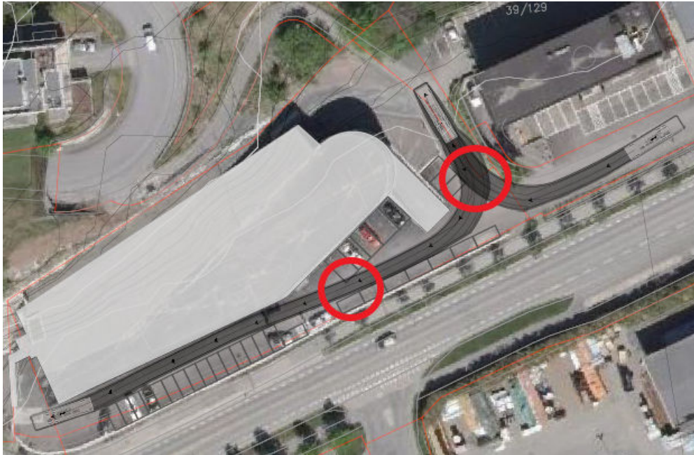
Figur 3: Trangt for lastebil å rygge bak, spesielt i området som er ringet rundt med rød sirkel. Det er trangt dersom det er parkerte biler eller utlånshengere. Svarte rektangler viser parkeringsplasser for biler og oppstilling for utlånshengere.
