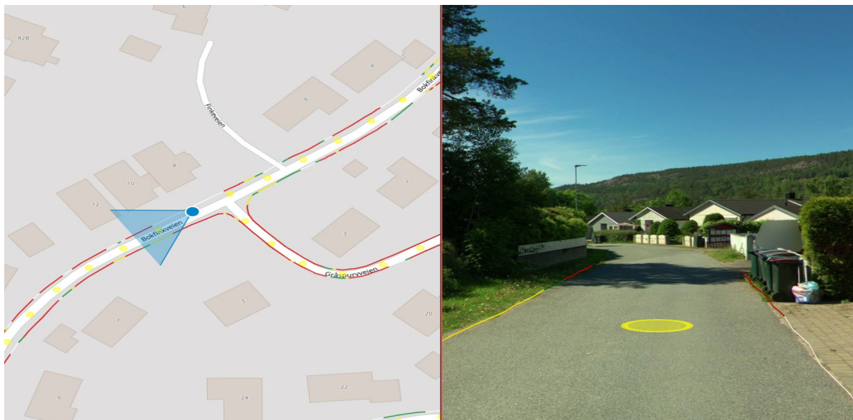
Figur 8 Utdrag fra analyse av sideareal, hvor rød strek indikerer objekt innenfor 1,5 m fra veikant, gul strek innen 2 m fra veikant og hvit strek ingen hinder. Kilde: Asker kommune, Mapspace/AVvei
