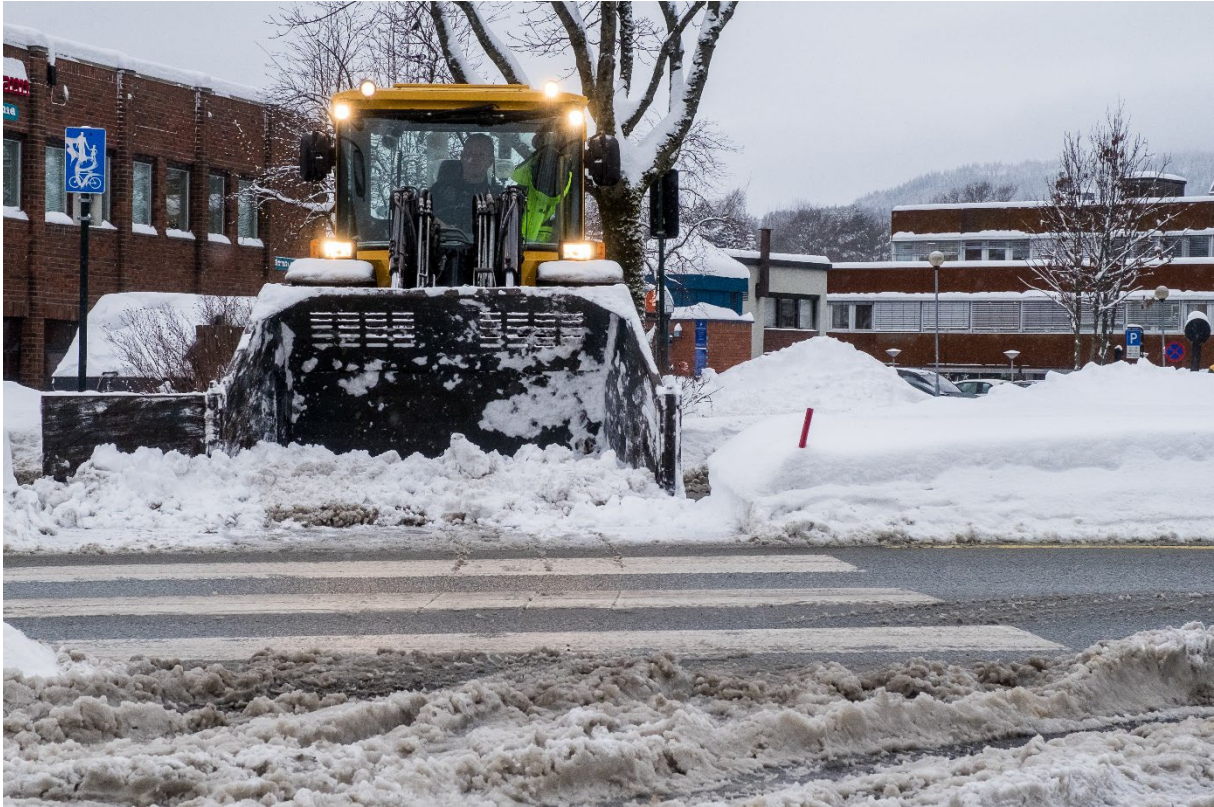
Figur 30 Overganger mellom gang og sykkelveier, gangfelt o.l. er kritiske soner, der hauger av gjenliggende snø kan være til stor hinder. Foto: Tove Lauluten.
