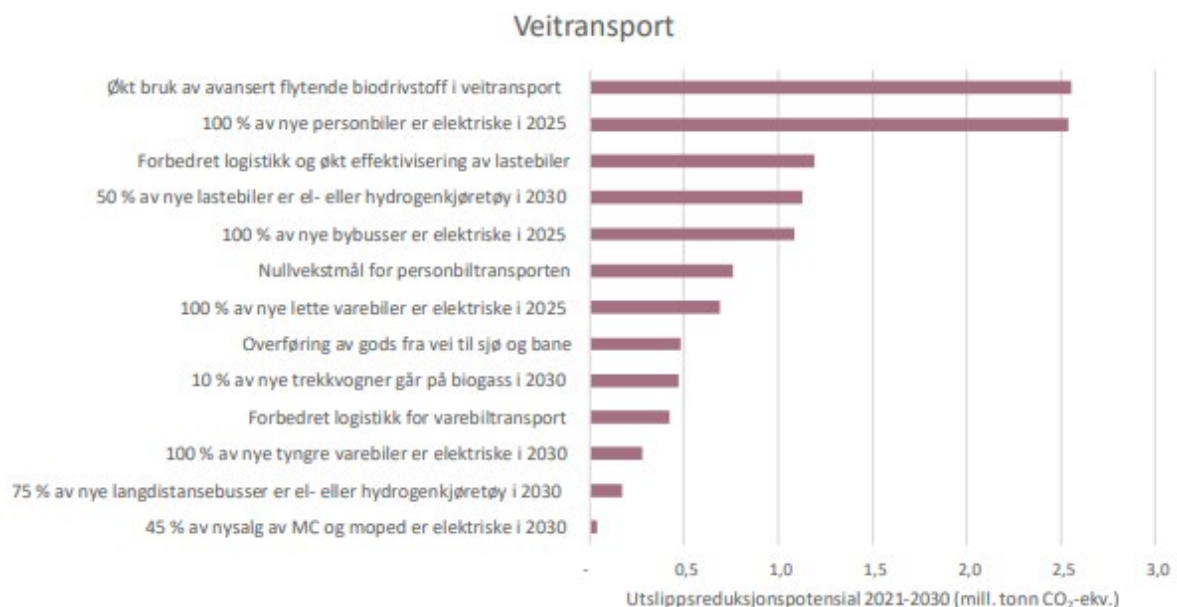
Figur 2 Utslppsreduksjonspotensial for tiltak innen veitransport 2021-2030 (mill. tonn CO 2 e) Kilde: Klimakurrapporten til Miljødirektoratet
