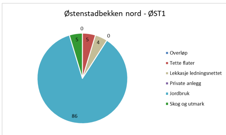
Figur 76 Teoretisk beregnet tilførsel av nitrogen for ulike kilder (%-andel) i nedbørfeltet til Østenstadbekken nord for 2021.
