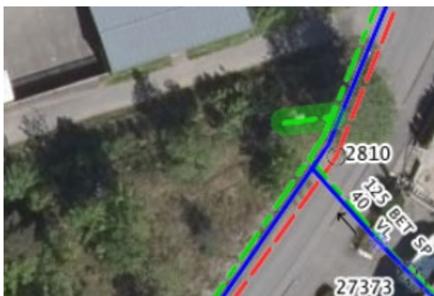
Figur 3 viser utlegg fra spillvannsledning i Torstadåsen.
