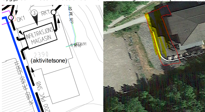
Figur 4 viser infiltrasjonssone under aktivitetsbaner. Bildet viser område med mulig vannansamling i dagens situasjon, hvis sandfang går fulle eller tilsvarende.
