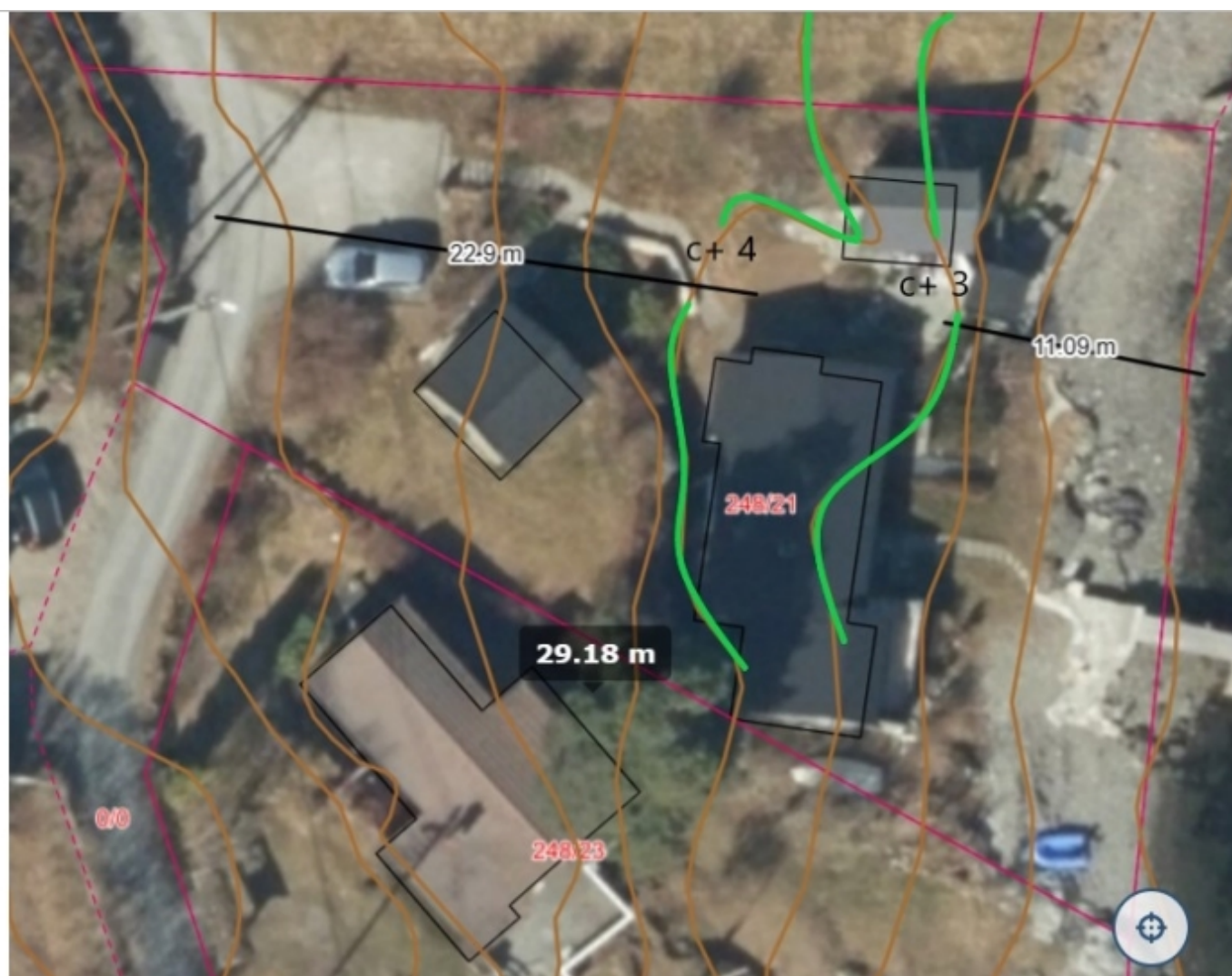
Flyfoto 1: Kyststien ligger på rundt kote c+ 8 m, dvs ca 5 m over plattingen på c+ 3 m. Platting er plassert innenfor et plant område. Oppføring har ikke krevd vesentlige terrengendringer
