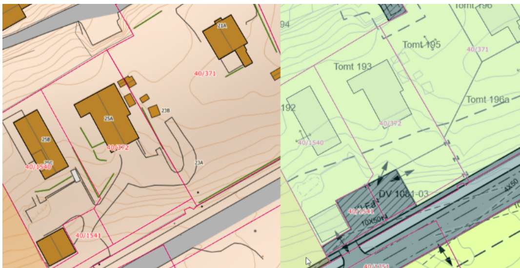
Figur 3. Kartutsnittet viser avviket mellom eksisterende eiendomsgrenser og det regulerte fellesarealet, herunder hvilken del av gbnr. 40/372 som skal føyes sammen med 40/1541.
