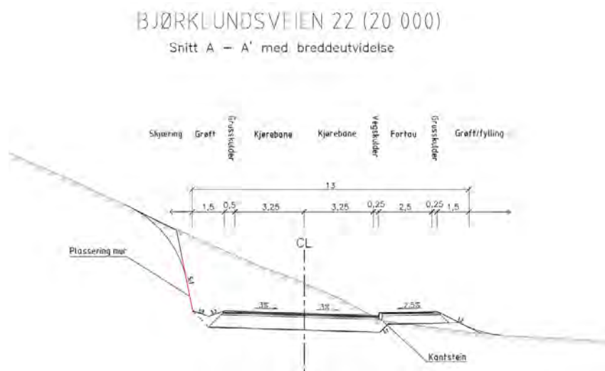
Illustrasjon fra Rambøll AS: Snitt ny vei og støttemur.
