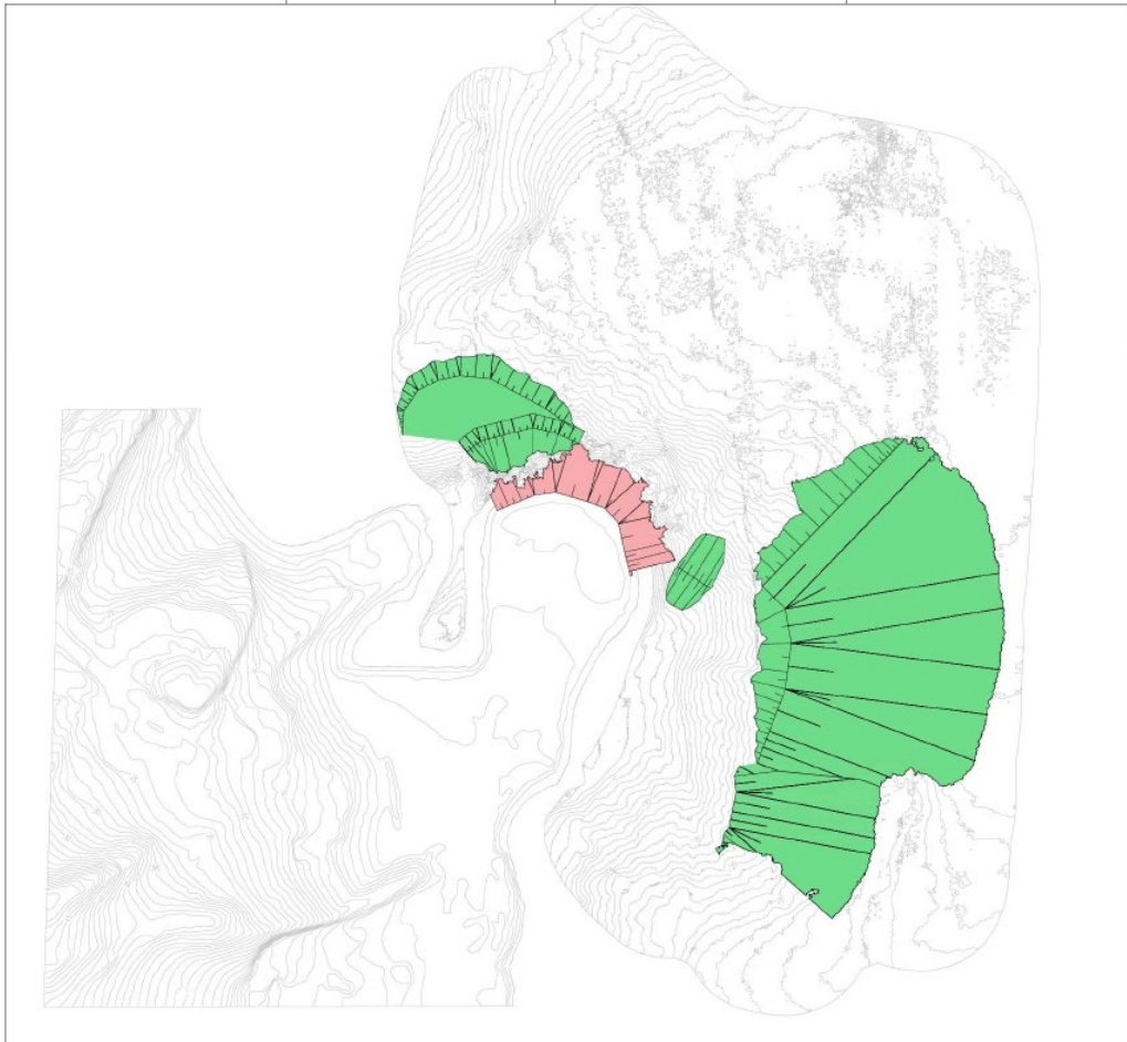
Figur 36 NGIs skisse med alternativ 3, avgraving av 15 000m 3 (rosa) på tuppen av Tåjeodden og motfylling i sjø på 100 000 m 3 (grønn).
