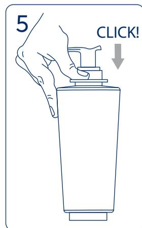
Abbassa la parte superiore della staffa per fissare il flacone e rimuovere la chiave
