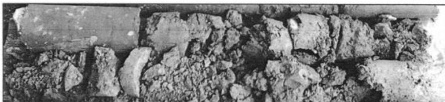
Slika 4. Deluvijalno-eluvijalni materijal, istražna bušotina B-5
