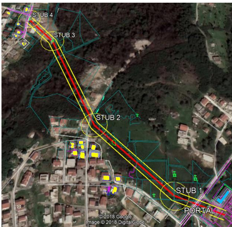
Slika 13. Prikaz trase dalekovoda koja je sa AutoCad crteža na katastarskoj podlozi i objektima preključena na Google Earth snimak predmetne lokacije
