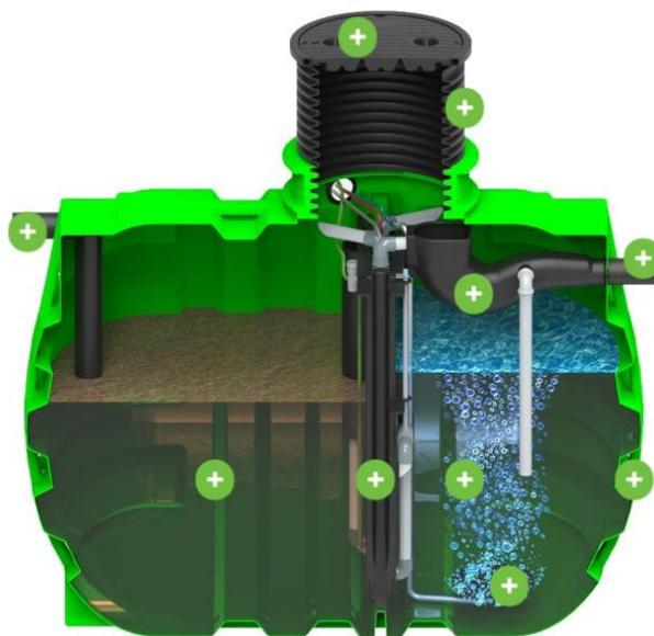
**Slika 10.** Vertikalni presjek biološkog prečišćavača, tipa Roco Roclean SBR 50 PE
