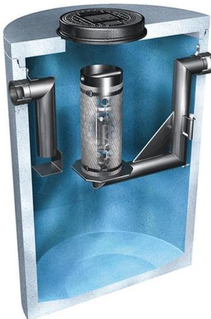
**Slika 11.** Vertikalni presjek sepoaratora ACO Oleopator C-FST
