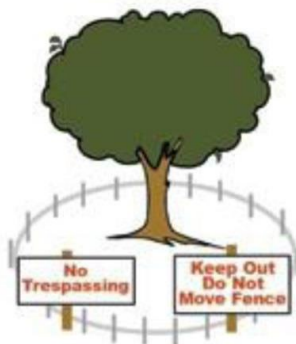
Slika 8.1. Postavljanje zaštitne ograde oko kritične zone korijena osigurava opstanak drveta
