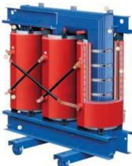
**Energetski transformatori:** Predviđeni su suvi energetski transformatori, pojedinačne snage 1000kVA, tip: GEAFOL Neo - 4GX6044-3EY prenosnog odnosa  $10.000V \pm 2x2,5\% / 400V$ , sprege Dyn-5 učestanosti 50 Hz, sa ugrađenih 6 PT100 senzora, radijalnim ventilatorima za prinudno hlađenje, antivibracionim podloškama i temperaturnim zaštitnim uređajem i kontrolerom ventilatora koji se montiraju u dovodnom NN trafo polju.
