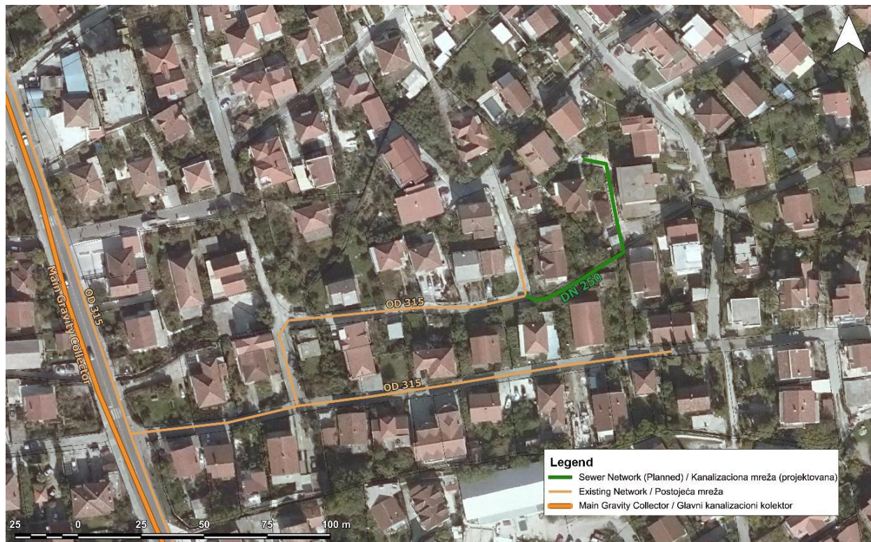
Slika 19. Situacioni prikaz nedostajućeg dijela kanalizacione mreže
