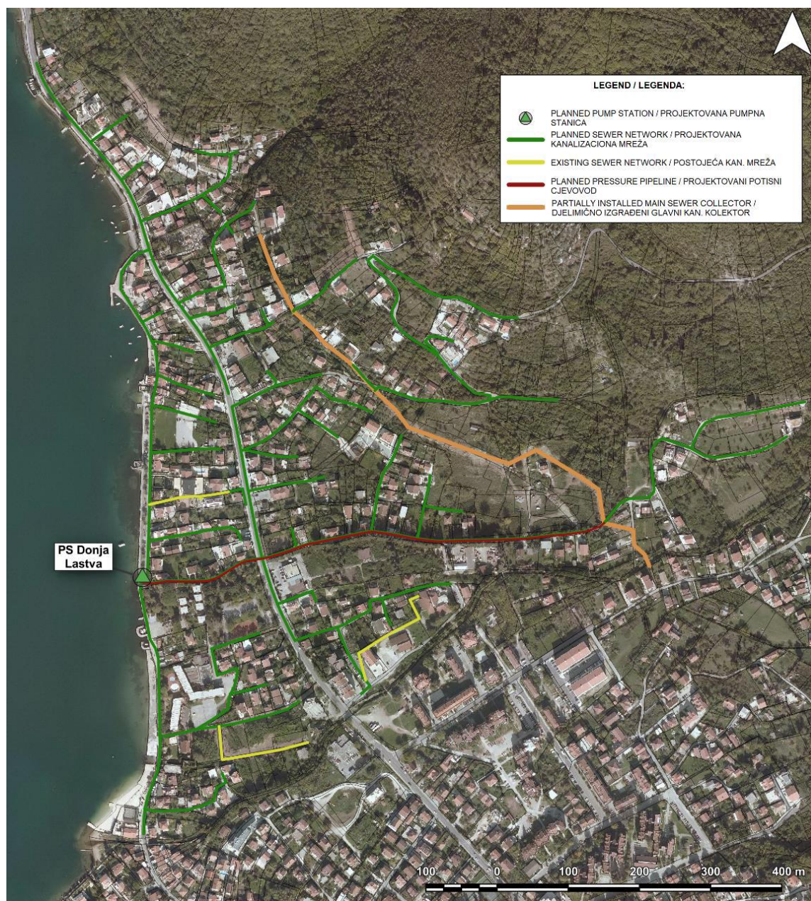
Slika 15. Pregled planiranog kanalizacionog sistema u Donjoj Lastvi
