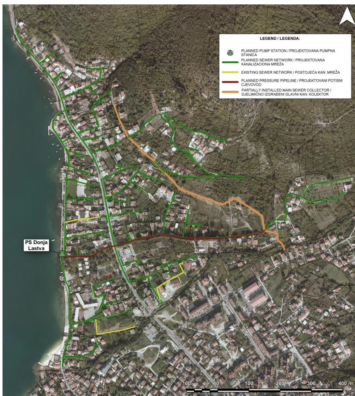
Slika 15. Pregled planiranog kanalizacionog sistema u Donjoj Lastvi
