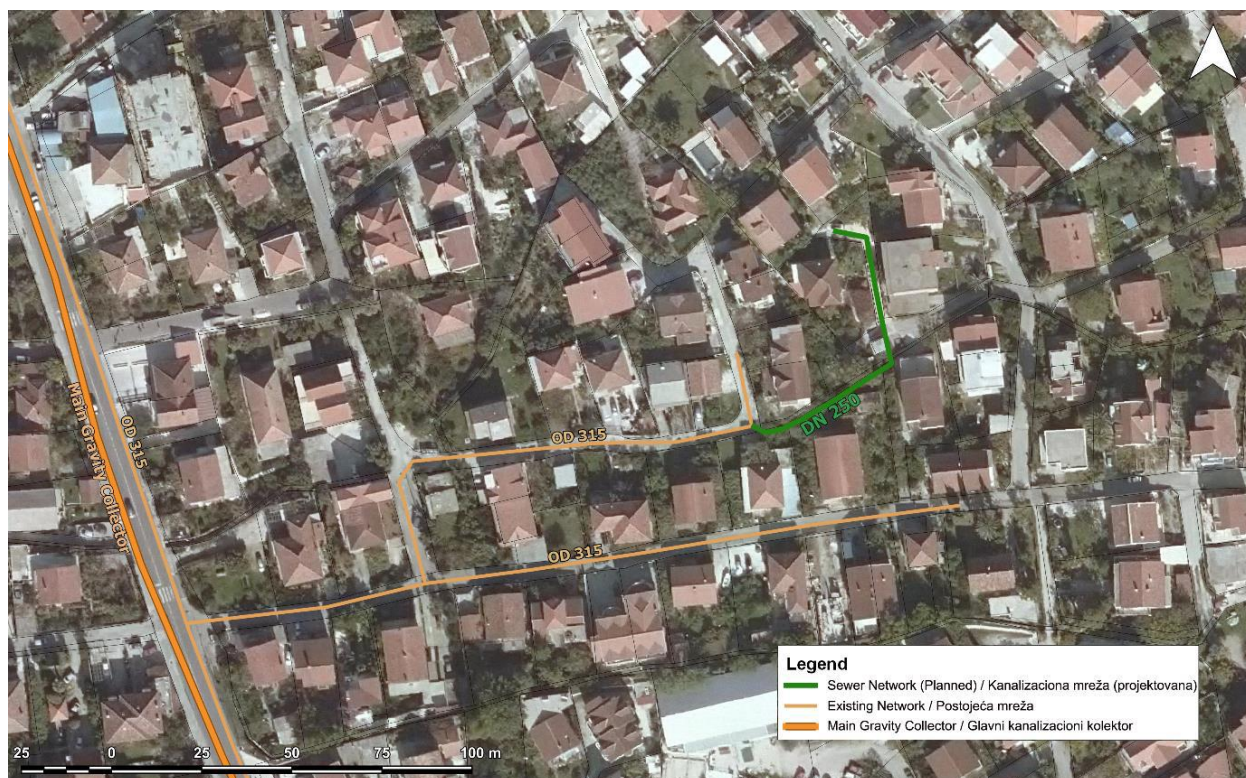
Slika 19. Situacioni prikaz nedostajućeg dijela kanalizacione mreže
