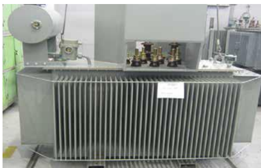
Slika 3.2. Izgled transformatora 10/0.4 kV, 1 x 630 kVA
