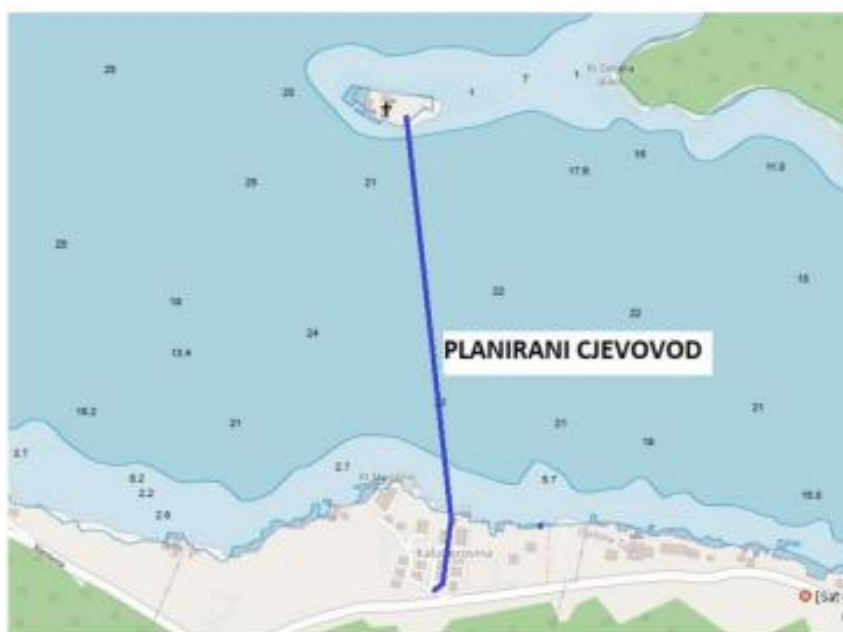
Slika 3. Karta sa dubinama mora i ucrtanom trasom cjevovoda za vodosnabdijevanje ostrva Gospa od Otoka (izvor: https://kotor.navarea.info/ )
