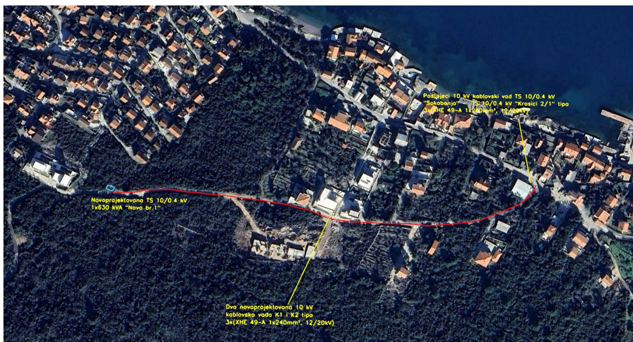
Slika 2. Lokacija trafostanice (oivičena plavom linijom) i trasa podzemnog kabla (označena crvenom linijom) sa užom okolinom.
