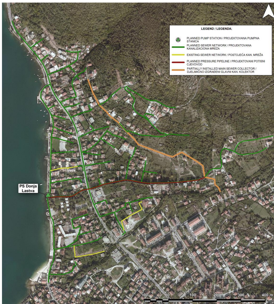
Slika 15. Pregled planiranog kanalizacionog sistema u Donjoj Lastvi
