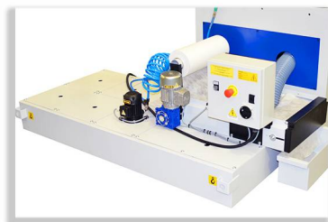
Vasca con avvolgimento automatico carta filtrante. Filtering system with automatic paper roll-up.
